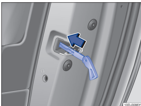
图 47 车门应急上锁装置及汽车钥匙
