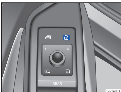
图 44 驾驶员侧车门内：中央门锁按钮
