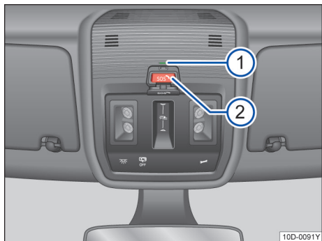
图 37 紧急呼叫操作元件：指示灯和按钮
