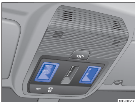
图 71 顶篷中控台：触摸感应式阅读灯
